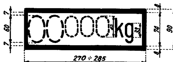
Fig. 2 Taravægt og bremsevægt 1) for vogne, som afbremses med en håndbremse, der kan betjenes fra en bremseplatform.
